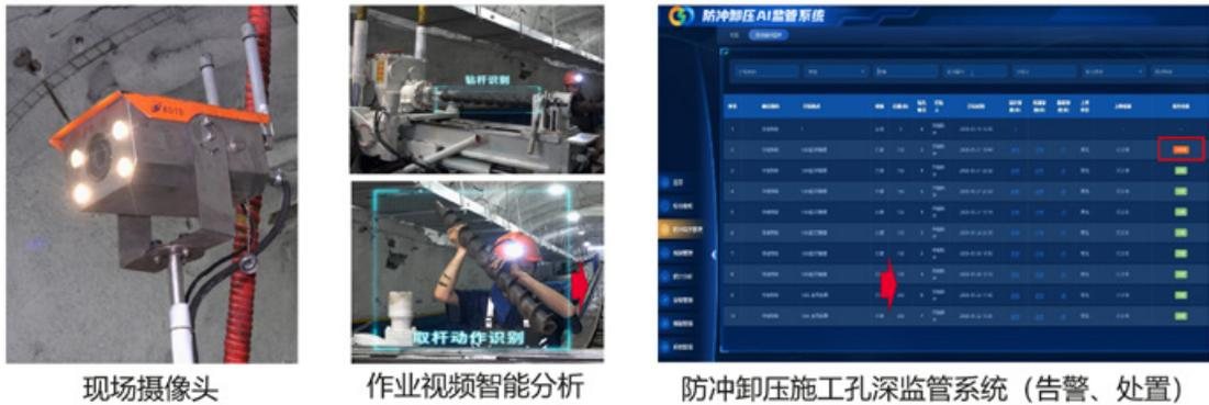
图 6-6 防冲卸压施工孔深监管部署示意
