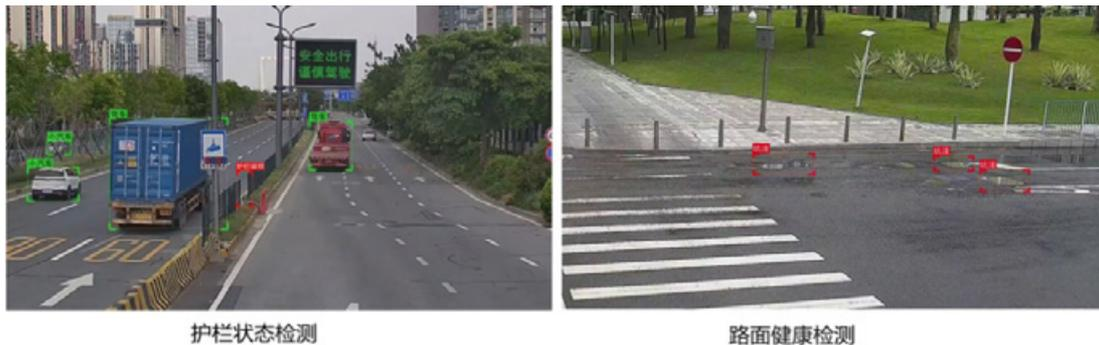
图 11-17 护栏状态监测和路面健康检测
