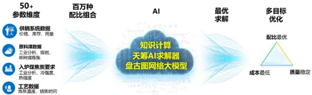
图 6-15 AI 智慧配煤原理示意
