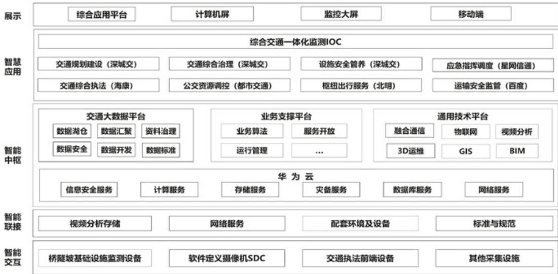
图 11-9 深圳交通运输一体化智慧平台总体架构
